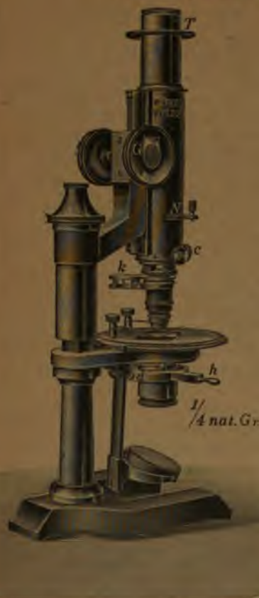
Neues einfaches Mikroskop Mod. IVa. für petrographische Studien.
